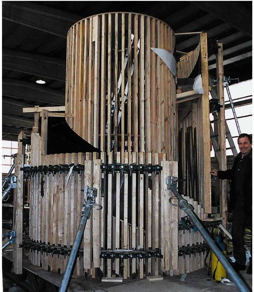
Rundschalungen für Fertigteiltreppen und Spindeltreppen fertigt die Firma Hohenadel.
